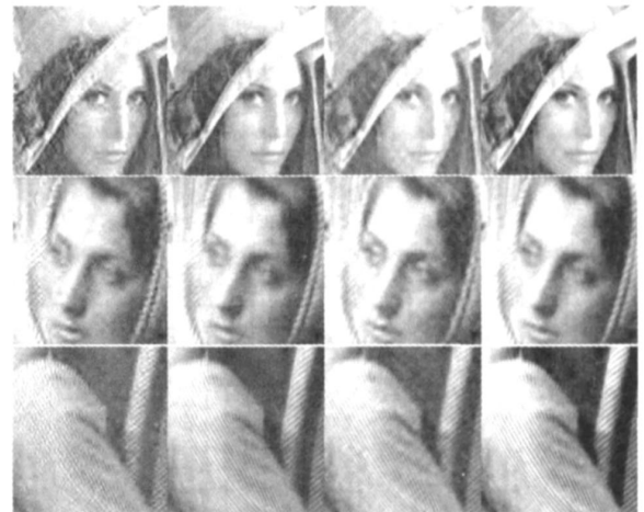
图 5 按列从左到右依次为小波 VisuShrink、ridgelet、curvelet 和本文方法的去噪结果, 其中噪声标准差为 20
